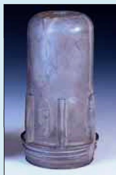
アロクロムアルミ処理 をしたものは腐蝕なし
